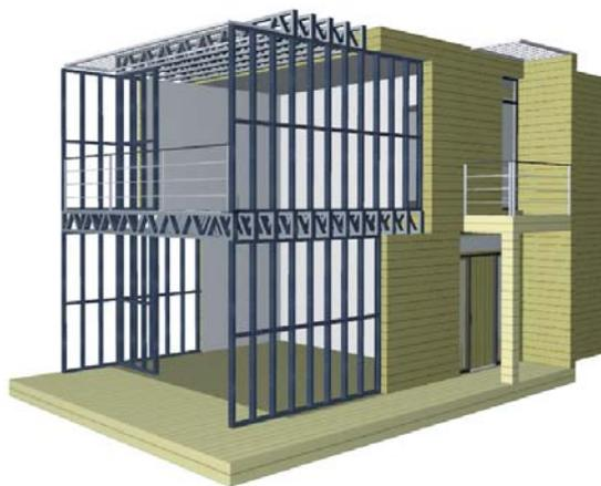
Le caratteristiche di leggerezza e flessibilità del sistema costruttivo steelMAX™ si evidenziano anche in interventi di ampliamento e sopraelevazione di strutture esistenti.
